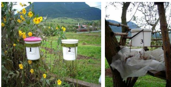
Obrázok 2: Umiestnenie prvých dvoch kolektorov (K1 – zakrytý kolektor, K2 – trvale otvorený kolektor)
